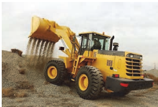
شکل ۱- لودر چرخ لاستیکی و چرخ زنجیری
