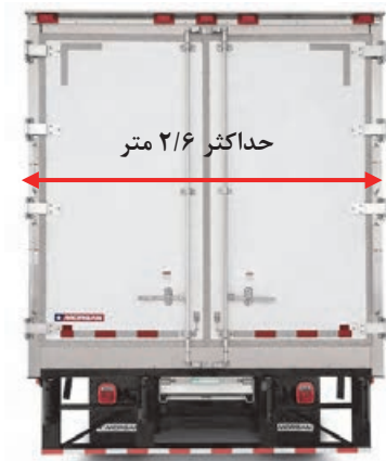
شکل ۳- حداکثر عرض مجاز وسایل نقلیه حمل بار
