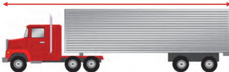
شکل ۴- حداکثر طول مجاز وسایل نقلیه حمل بار
