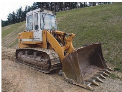
شکل ۱- لودر چرخ لاستیکی و چرخ زنجیری
