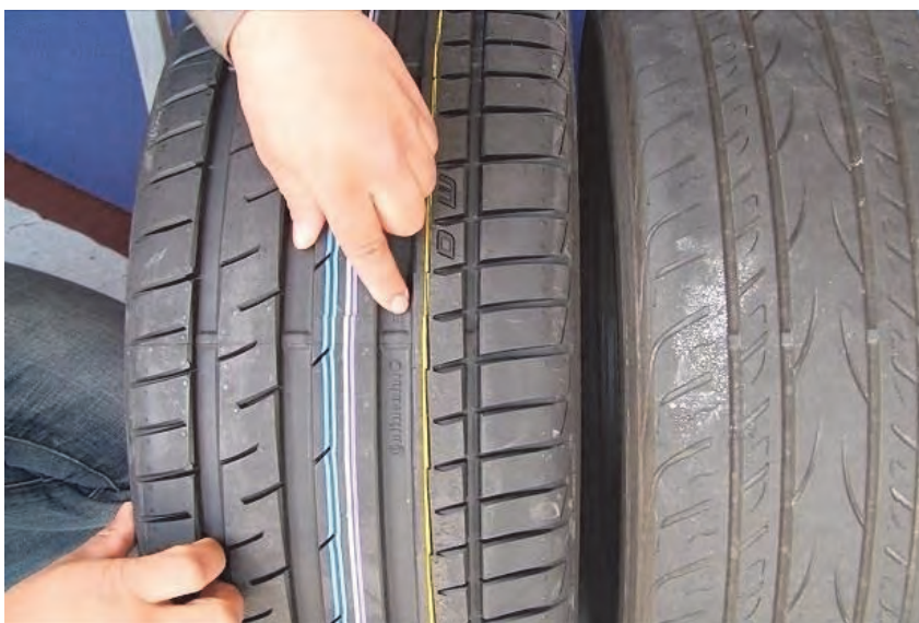
شکل ۱۳- فرسایش لاستیک‌ها بر اثر وزن غیرمجاز بار
