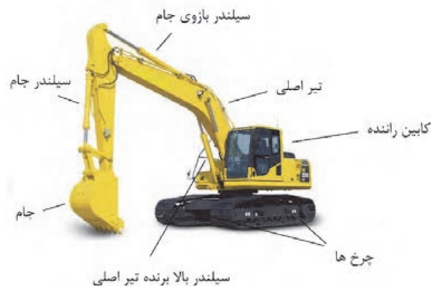
شکل ۵- قسمت‌های مختلف بیل مکانیکی
