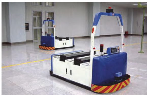
شکل ۲۸- ماشین اتوماتیک هدایت شونده با لیزر
